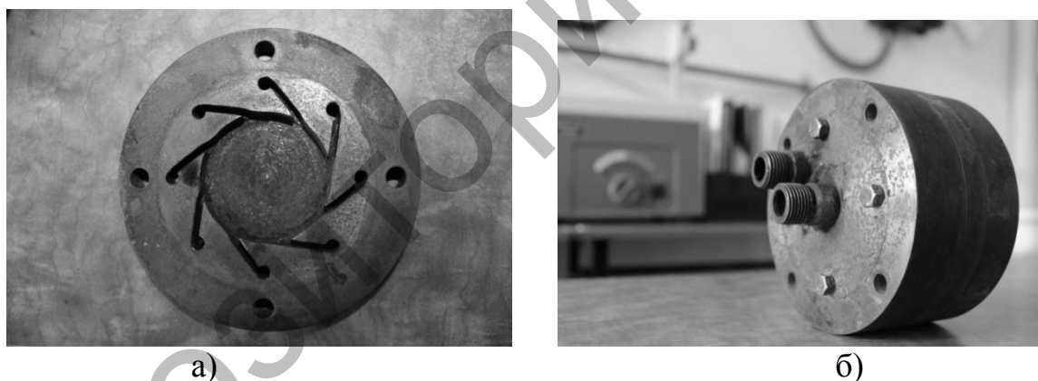
Рисунок 7 – Форсунка с тангенциальной закруткой для распыления водоугольного топлива (а- внутренняя часть с тангенциальной закруткой; б – общий вид)
