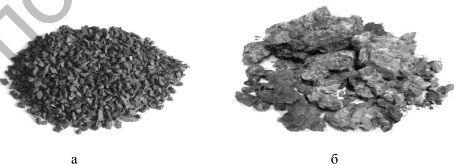
Рисунок 2 - Уголь сарыадырский до (а) и после (б) термообработки при температуре 1650°С
